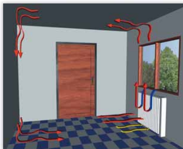
Předávání tepelné energie do prostoru
