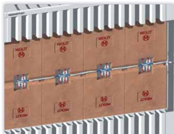
Pohled na zapojení topných cihel v panelu
