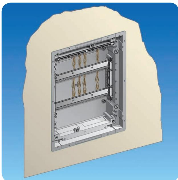
Samozhášivá plastová skříňka pro instalaci do stěny je odolná proti deformaci a lomu, a poskytuje dostatečně velký prostor pro připojení vodičů. Součástí skříňky je hřeben pro uchycení vodičů k odlehčení tahu na svorkách přístrojů.
